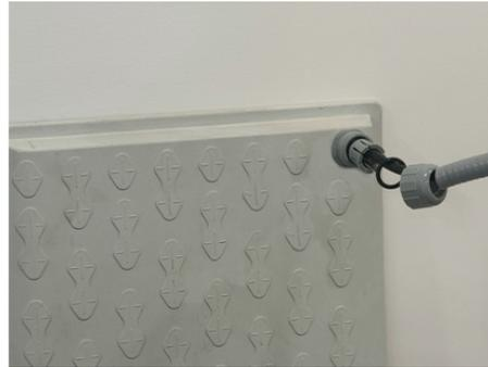
b) Deslice la tuerca sobre el conducto flexible de 3/8", asegúrese de que la junta resistente al agua esté alineada correctamente, luego empuje el conducto firmemente dentro del conector y vuelva a apretar la tuerca.
